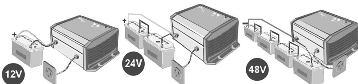
Der AJ wird mit angeschlossen Batteriekabeln geliefert. **Beim Anschliessen der Batterie muss unbedingt auf die richtige Polarität geachtet werden.**
